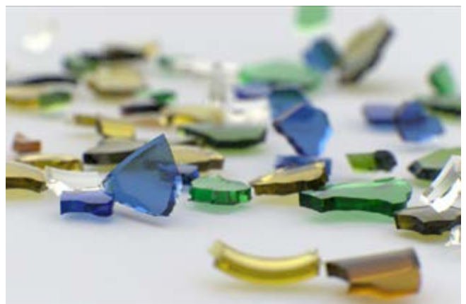
Abb. 2b: Synthetisch erzeugte Glasscherben und sensorrealistische Bildsynthese zur Entwicklung von Sichtprüfsystemen.
